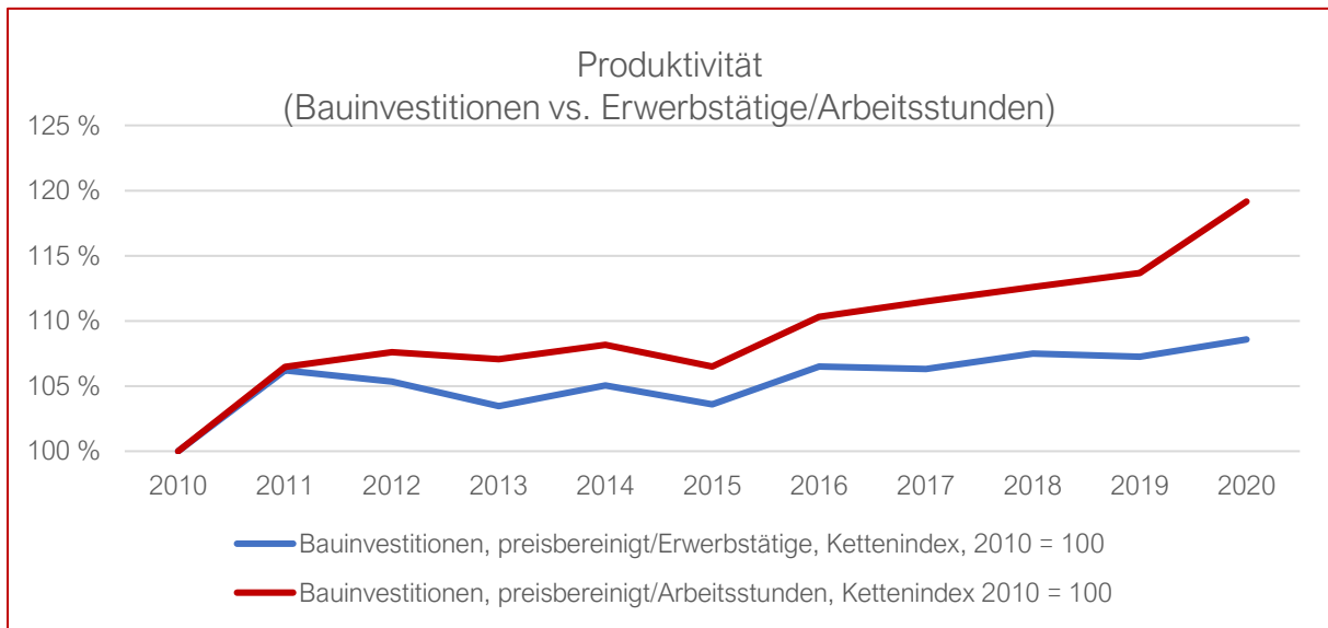
Abbildung 6: Entwicklung der Arbeitsproduktivität in Bezug auf die Erwerbstätigen (blau) bzw. die geleisteten Arbeitsstunden (rot); mit Bereinigung der Effekte der Preissteigerung [3]
